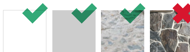
omítka, bílý nátěr RAL 9010 bet. mazani-na, omítka, bleděšedá RAL 7030 kamenné zdivo obklady
