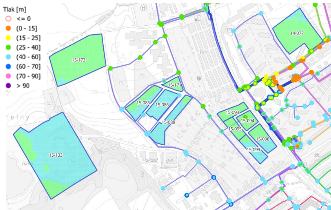
Obrázek 5.9: Tlakové poměry, optimalizovaný stav
