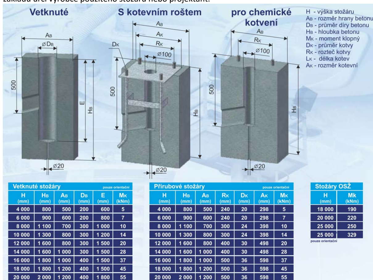
Obr. 30 - Doporučené charakteristiky základů pro kotvení stožárů(zdroj: www.kooperativa-vod.cz)
